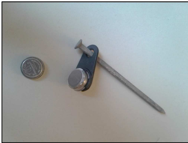
Abb. 2: I-Button Thermologger mit Plastikhalterung und Verankerung zur Befestigung in der Nestmulde.
