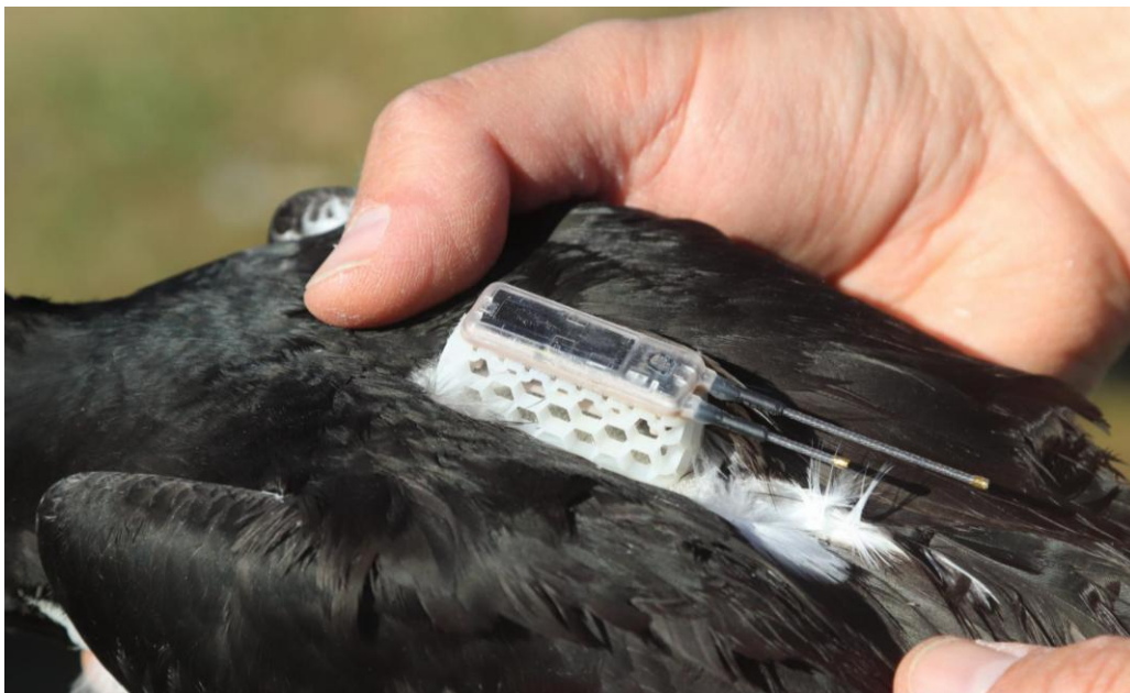
Abbildung 4: Detailaufnahme der im Berichtsjahr verwendeten GPS-Logger. Jeder Logger wurde in eine Erhöhung eingeklebt, die durch ihre wabenartige Struktur sehr leicht und stabil ist. Zentral obendrauf befindet sich das Solarpanel, Daten können über die zwei nach hinten ragenden Antennen empfangen und gesendet werden. Foto: P. Gienapp, Arlau 2025.
